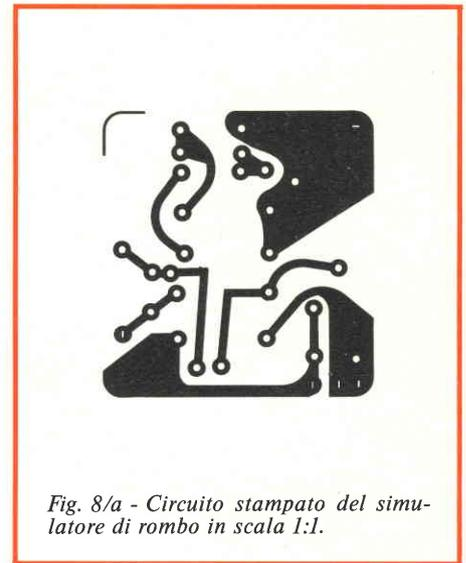
Fig. 8/a - Circuito stampato del simulatore di rombo in scala 1:1.
